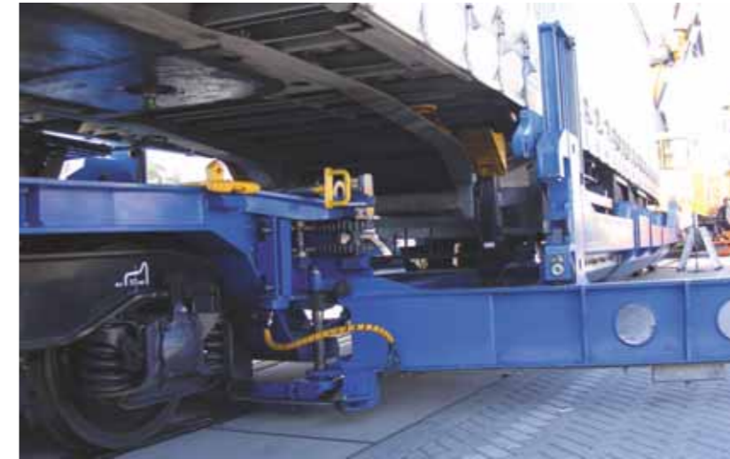
Das Unternehmen Kockums Industrier aus Schweden entwickelt spezielle Niederflur-Taschenwagen mit schwenkbarer Aufnahmwanne vom Typ Megaswing.
