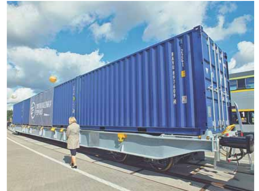
Der 80 Fuß lange Containertragwagen der Firma Tatravagonka wurde auf der Innotrans 2012 vorgestellt.
