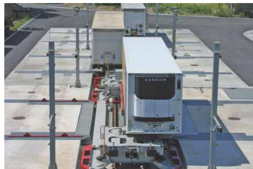
Cargo Beamer ist das Konzept für die Verladung nicht kranbarer Sattelaufleger.
